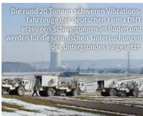
Die rund 20 Tonnen schweren Vibrationsfahrzeuge der deutschen Firma DMT erzeugen Schwingungen im Boden und werden für die seismischen Untersuchungen des Untergrundes eingesetzt.
